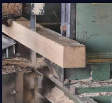
Balken aufgesägt Innenfurniere = 2. Patina Beams sawn open Inside veneers = 2. Cut
